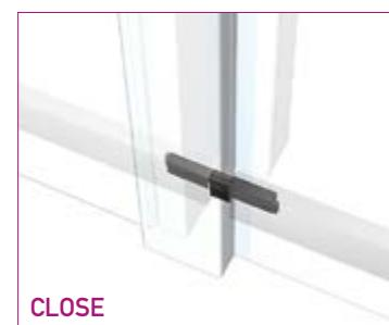
**IT** Accessorio che chiude la fessura tra catenaccio e guarnizione automatica sotto-porta, presente nella zona nodo centrale su porte blindate a doppio battente. Il modello NO AIR DOUBLE BLINDO è composto da due pinne di tenuta collegate alle guarnizioni automatiche sotto-porta presenti sull'anta semifissa e sull'anta semimobile. Può essere installato su tutte le guarnizioni automatiche sotto-porta della gamma C.C.E. con altezza 28/30/40mm.
