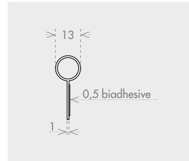
**FR** Système de protection contre l'écrasement des doigts pour les portes battantes, le plus léger et simple possible. Il s'installe rapidement avec un bi-adhésif et protège le point de cisaillement entre la porte et le cadre à l'intérieur de la charnière des portes en bois. Associé au modèle DIGISAFE120 et DIGISAFE180, il assure une protection totale contre l'écrasement des doigts et permet une ouverture de la porte jusque 180°.
