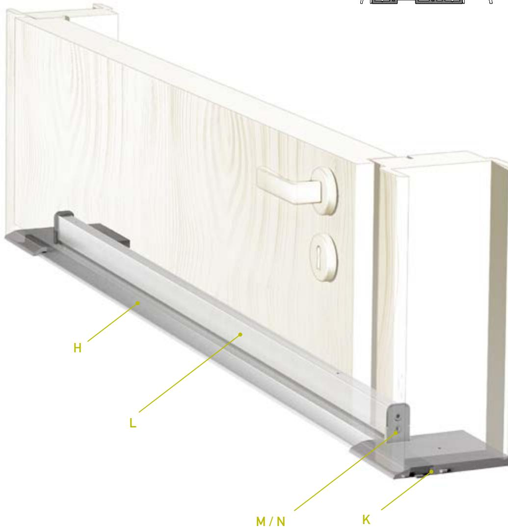
**IT** Ideale per i portoni d'ingresso in legno, il sistema Termo Ulisse Wood utilizza la soglia con taglio termico in PVC e dei tamponi sotto-montante, che possono essere profilati in opera sui montanti di ogni serramento. Questo consente di avere una tenuta perfetta della garnizione sottoporta con la soglia a pavimento. Ideale l'utilizzo in combinazione con i terminali laterali NO AIR.
