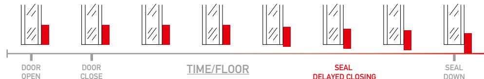
**IT** Sul modello Glass abbiamo applicato la tecnologia Chrono a discesa idraulica ritardata (brevetto CCE), rendendolo ancora più performante. La guarnizione scende solo qualche secondo dopo che la porta è già chiusa, evitando attrito con il pavimento e rumore. Su questo modello è necessario scegliere se va applicato su porte con apertura destra o sinistra.
