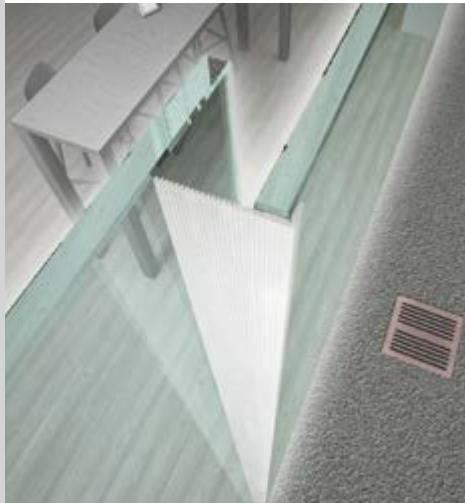
**IT** GLASS LIP SLIDE è una guarnizione per porte scorrevoli in vetro di semplice e veloce installazione che si fissa tramite un adesivo ad alta tenuta. Il labbro di tenuta, accorciabile a strappo per ogni millimetro, permette la chiusura di fessure da 12 fino a 30 millimetri, su vetri di spessore da 8 mm a 14 mm.
