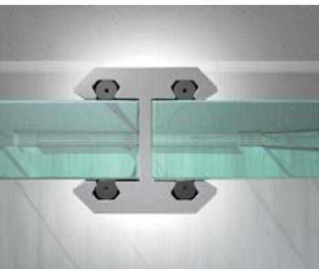
**IT** Complementari alla guarnizione perimetrale GLASS FRAME, vengono utilizzati per eseguire giunzioni tra due vetri diversi. Il profilo di alluminio anodizzato ha al suo interno delle morbide guarnizioni di tenuta anti-vibrazione che permettono di compensare fessure da un minimo di 4 mm ad un massimo di 8 mm. Disponibile per vetri di spessore 10 / 12 mm.
