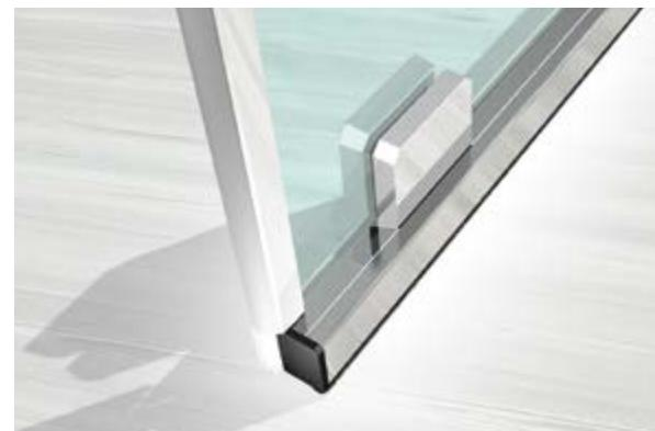
**IT** Guarnizione sottoporta per porte in vetro che può essere installata su tutti i sistemi tradizionali a cerniera e sui sistemi pivotanti con pompa a pavimento. Mediante un apposito compensatore, è possibile allineare la guarnizione sottoporta, vincendo il dislivello tra la porta in vetro e lo spessore della piastra del pivot. Disponibile in diverse finiture di anodizzazione.
