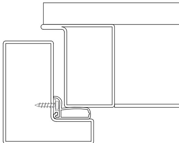
**IT** Guarnizione universale per porte blindate (battuta da 25 mm) composta da un profilo di alluminio ed una morbida guarnizione. Alte prestazioni di tenuta acustica e ottimo complemento per rispettare gli standard di certificazione CE del serramento.
