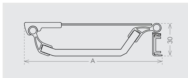
**IT** Sistema di protezione antisciacchiamento dita per porte e portoni a battente con apertura fino a 120°, composto da una elegante e solida scocca in polycarbonato trasparente (UV resistant). Grazie alla possibilità di personalizzare la curvatura e la posizione delle pieghe, DIGIPLEXI può adattarsi a tutti i tipi di serramento a battente.
