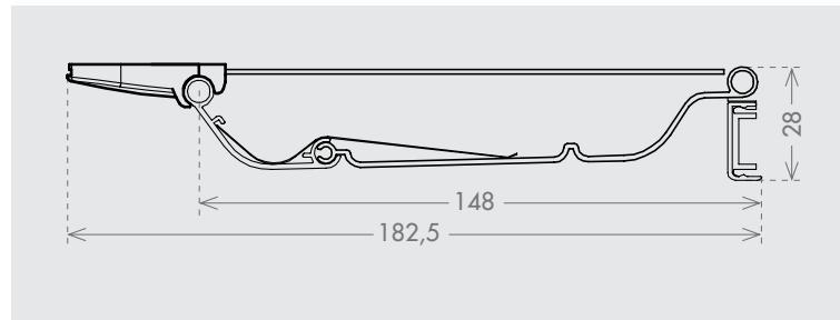
**IT** Sistema di protezione antischiacciamento dita per porta a battente, protegge il punto di cesoimentato tra porta e telaio sul lato interno della cerniera. È costituito da più profili di alluminio incernierati tra loro che permettono alla porta una apertura fino a 180° (DG-SMAX180) e la protezione totale del punto interno di cesoimentato tra porta e telaio.
