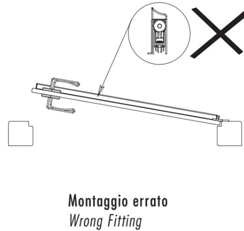
**2** MONTAGGIO SU PORTE A BATTENTE SENZA TELAIO
