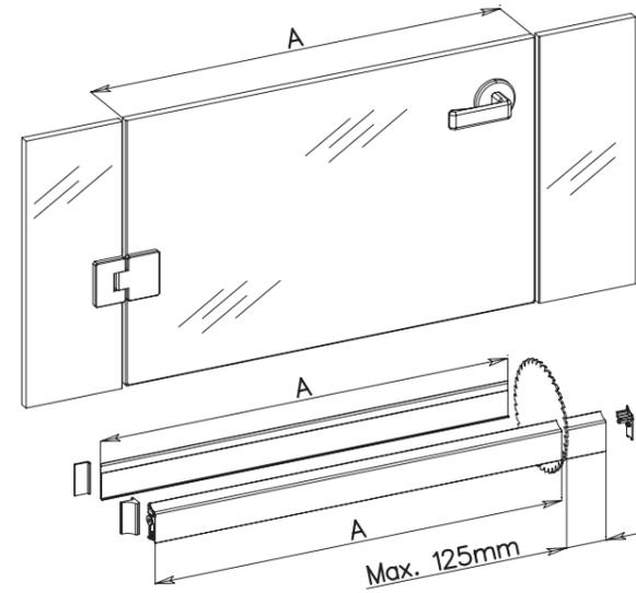
**7** MONTAGGIO DELLA GUARNIZIONE AUTOMATICA
