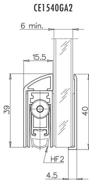
**1** MONTAGGIO SU PORTE A BATTENTE CON TELAIO METALLICO
