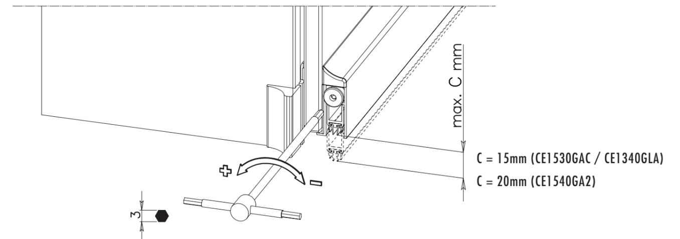
Agendo sul pulsante di spinta si regola la corsa / pressione della guarnizione
