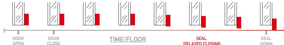
**IT** Sul modello Glass abbiamo applicato la tecnologia Chrono a discesa idraulica ritardata (brevetto CCE), rendendolo ancora più performante. La guarnizione scende solo qualche secondo dopo che la porta è già chiusa, evitando attrito con il pavimento e rumore. Su questo modello è necessario scegliere se va applicato su porte con apertura destra o sinistra.
