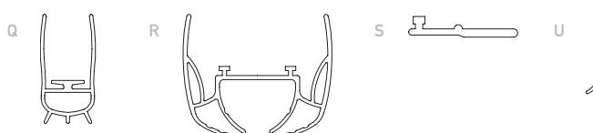
Guarnizione in materiale termoplastico antifiamma monoestruso.
