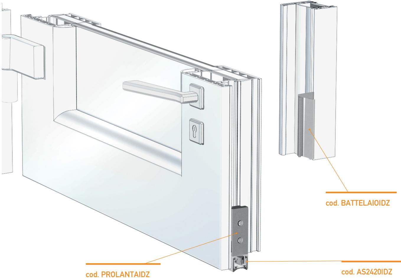
**IT** IDROZERO è un sistema brevettato di tenuta all'acqua per portoncini in PVC ad anta singola, che consente il raggiungimento di alte prestazioni di tenuta (fino a Classe 9A secondo lo standard UNI EN 12208), su serramenti adeguati e con corretta installazione, senza l'utilizzo di una soglia a pavimento, eliminando totalmente le barriere architettoniche. Il sistema, con alcune personalizzazioni, può essere utilizzato anche su portoncini in legno o alluminio.
