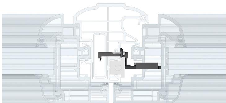
**IT** Accessorio che chiude la fessura tra catenaccio e guarnizione automatica sotto-porta, presente nella zona nodo centrale su serramenti a doppio battente in PVC. Il modello NO AIR DOUBLE PVC è composto da un sistema di tenuta montato sulla anta semifissa (catenaccio) e da un sistema automatico montato sull'anta mobile.
