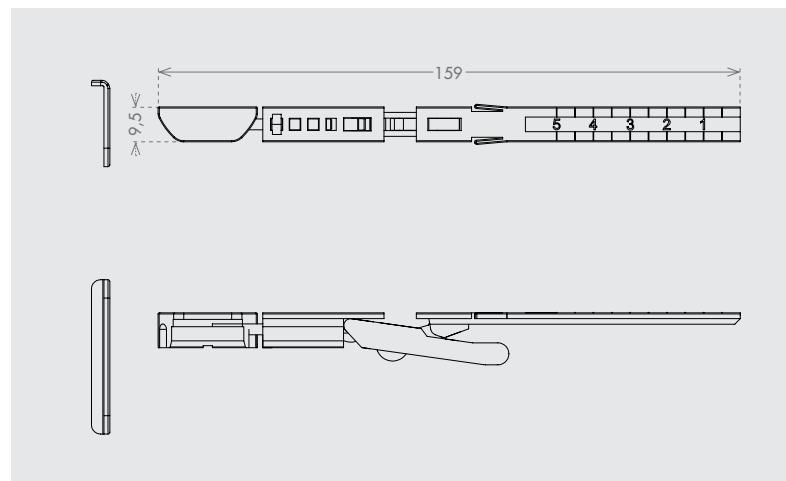
**IT** Il KIT DOPPIO PULSANTE permette di far chiudere a terra la guarnizione automatica sul lato maniglia solo quando la porta è completamente chiusa. La guarnizione scende grazie alla pressione del pulsante di spinta sul lato cerniera e chiude completamente a terra quando il secondo pulsante viene premuto. In questo modo è possibile ottenere il massimo della tenuta su tutta la sua lunghezza.
