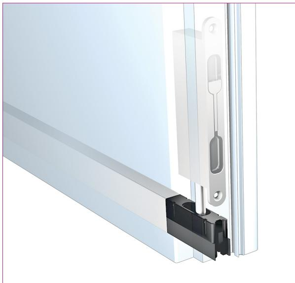
**IT** Accessorio da utilizzare su porte a due ante dotate di catenaccio come in figura. Permette di creare continuità tra le guarnizioni automatiche sotto-porta dell'anta semifissa e semimobile. Da utilizzare sui modelli MAXI FILLER, ACOUSTIC PLUS, ACOUSTIC BLINDO, DROP 20 MAXI, ACOUSTIC PLUS TERMOESPANDENTE.
