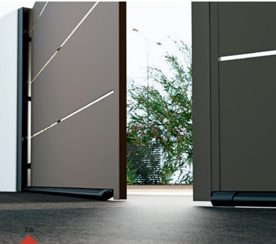
Das geneigte Profil erhöht die Leistung der Sicherheitskante gegen die Gefahr des Mitreißens. In Kombination mit der COMPATTA-Sicherheitskante verringert es den Abstand zwischen Flügel und festem Element um 24 mm. Mit MINI/MINIROLL an Drehtoren verringert es den Abstand zwischen Flügel und Boden um 13 mm.
